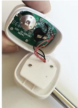
**MessStick** Der MessStick ist bis auf zyklischen Wechsel der Batterie wartungsfrei. Zum Batteriewechsel das Gehäuse öffnen und Batterie ersetzen (siehe links). Es kann sinnvoll sein, den Stick in Zyklen zu kalibrieren. Sehen Sie hierzu unser Handbuch zum Kalibrierungsset, dass wir Ihnen gerne senden.
