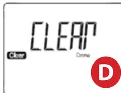
Die Funktion „CLEAR“ (siehe D) ermöglicht es dem Benutzer, den kumulierten Durchflusswert zu korrigieren. Durch Auswahl dieses Menüs wird der kumulierte Durchfluss zu Null. Nach dem Drücken von FUN zeigt der Bildschirm die Einstellung „Setting“, bitte nicht unterbrechen bis „Done „angezeigt wird. Der Bildschirm kehrt dann automatisch zum Menüauswahlbildschirm zurück.
