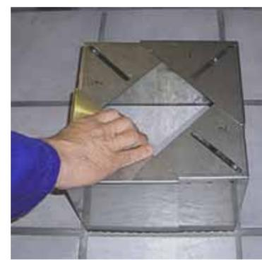
Die Edelstahlblechsätze sind aus 4 großen und 4 kleinen Winkeln konzipiert. Hierzu passend erhalten Sie Abdeckplatten zur Befestigung der Bleche miteinander. Die Befestigung erfolgt mit Käfigmuttern und Flügelschrauben. Ebenso ist im Blechsatz der Adapter zur Aufnahme der Heißluftpistole enthalten. Edelstahlblechsätze sind erhältlich für die Formate 30 x 30 cm, sowie für 40 x 40 cm. Zur Aufrüstung von 30 x 30 cm auf 40 x 40 cm ist ebenso ein Set lieferbar.
