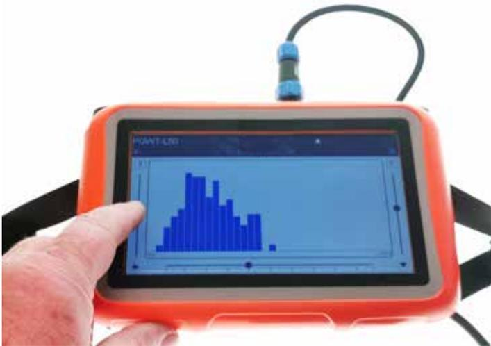
Das Gerät ermöglicht Ihnen die Frequenz des Geräusches perfekt zu isolieren und Nebengeräusche gut abzufiltern. Sehr gute Möglichkeiten bietet Ihnen die Langzeitmessung, in der Sie das betroffene System drucklos machen können und so erkennen, ob das Leckgeräusch abflacht. Die Funktionen und Möglichkeiten sowie die gute Ablesbarkeit im großen Display werden Sie begeistern.
